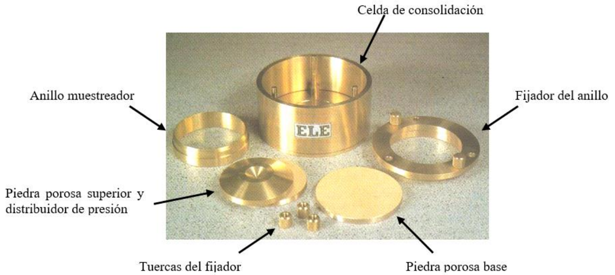
Figura 118. Consolidómetro de anillo fijo (ELE).
