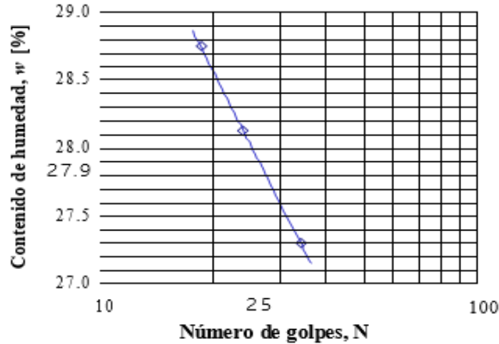
Figura 35. Determinación del valor del límite líquido.
