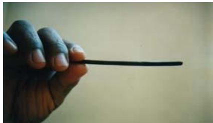
Figura 7. e) Enrollar el espécimen en rollo de 3 mm. f) Ruptura producida a los 3 mm de diámetro.
