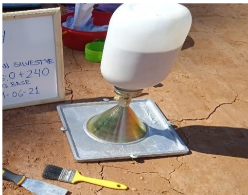
Figura 97. Llenado del hoyo con arena tipo Ottawa.
