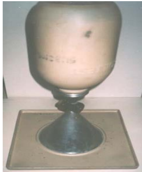
Figura 94. a) Pesaje de botellón + cono + arena. b) Calibración de cono.
