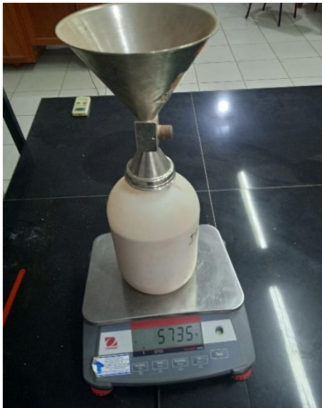
Figura 94. a) Pesaje de botellón + cono + arena. b) Calibración de cono.
