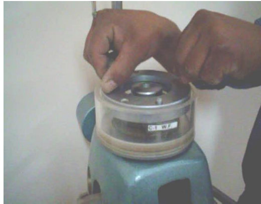
Figura 121. Armado del equipo de consolidación.
