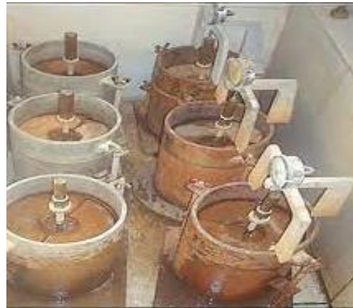
Figura 100. a) Lectura inicial antes de sumergir. b) Sumergiendo en agua 96 horas.
