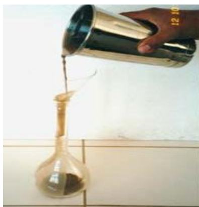
Figura 65. Vaciado de la muestra al picnómetro.
