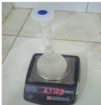
Figura 60. Pesada picnómetro más agua.
