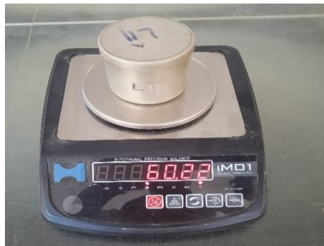
Figura 10. Determinación de la masa del contenedor
