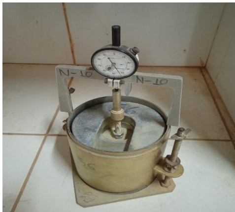
Figura 100. a) Lectura inicial antes de sumergir. b) Sumergiendo en agua 96 horas.
