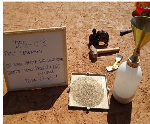
Figura 97. Llenado del hoyo con arena tipo Ottawa.
