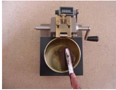
Figura 25. Colocación de la muestra en el aparato de Casagrande
