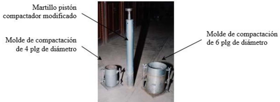
Figura 83. Equipo de compactación en laboratorio.
