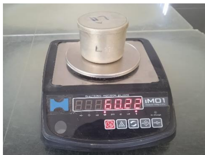
Figura 47. Pesado del recipiente de vidrio más mercurio.
