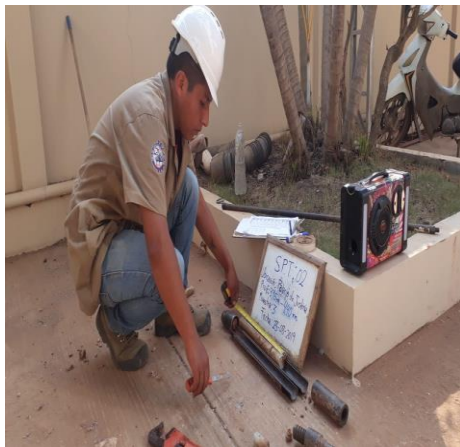
Figura 111. a) Toma de muestra de SPT. b) Cuchara bipartita más la muestra extraída.
