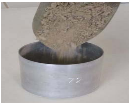
Figura 11. Disposición de la muestra en el contenedor
