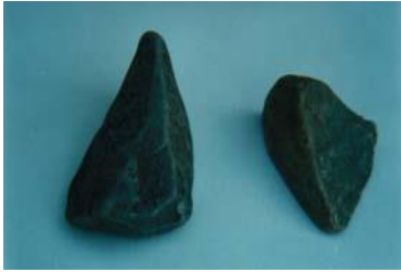
Figura 1. a) Partículas angulares b) Partículas subangulares c) Partículas subredondeadas
