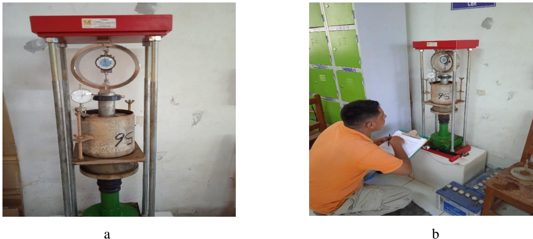
Figura 101. a) Molde con suelo + pistón. b) Registrando los valores de penetración.
