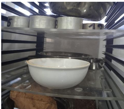
Figura 72. Secado de la muestra en el desecador.
