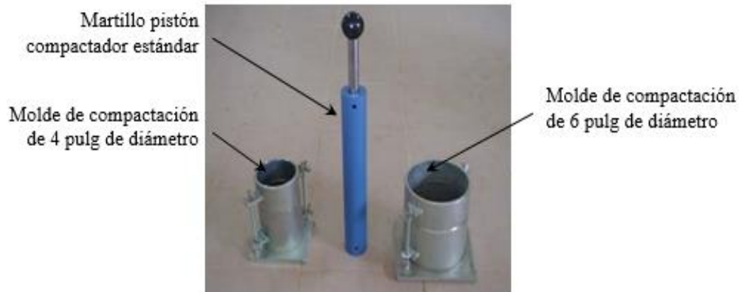
Figura 74. Equipo de compactación en laboratorio.
