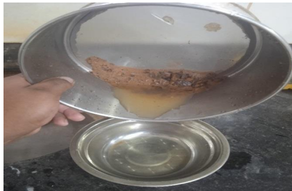
Figura 18. Vertido del material después del lavado.
