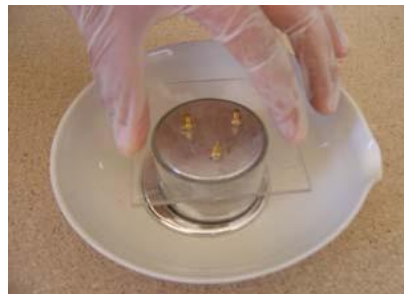
Figura 46. Enrasado del mercurio en el recipiente de vidrio.
