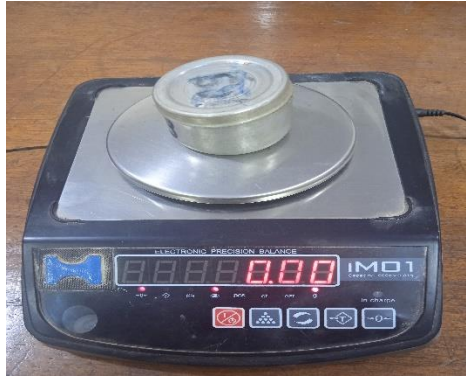
Figura 50. Pesado del recipiente de vidrio más el mercurio sobrante.
