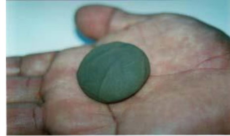
Figura 5. a) Moldear esfera de 1 pulg dividir en tres de ½ pulg b) Presionar con los dedos
