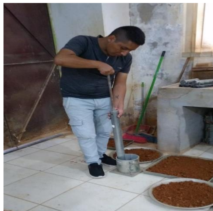
Figura 81. Compactación de la muestra.
