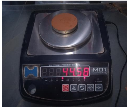
Figura 44. Pesado del recipiente de contracción más mercurio.
