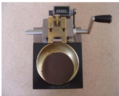
Figura 26. Muestra en el aparato de Casagrande. a) vista en planta. b) vista frontal.
