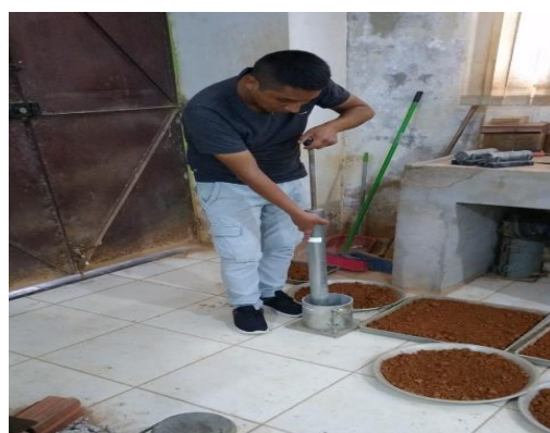
Figura 90. Compactación de la muestra en el molde
