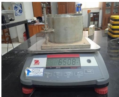
Figura 89. Determinación la masa del molde
