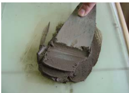
Figura 24. Mezclado de la muestra
