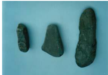
Figura 1. a) Partículas angulares b) Partículas subangulares c) Partículas subredondeadas
