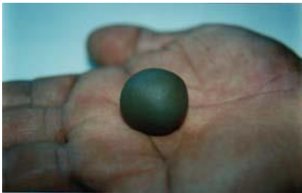
Figura 5. a) Moldear esfera de 1 pulg dividir en tres de ½ pulg b) Presionar con los dedos
