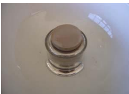
Figura 48. La muestra seca flotando sobre el mercurio.
