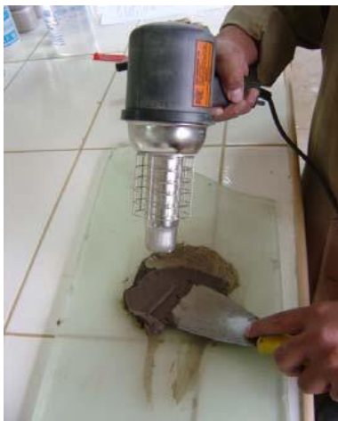
Figura 31. Reducción del contenido de humedad con la ayuda de una secadora.
