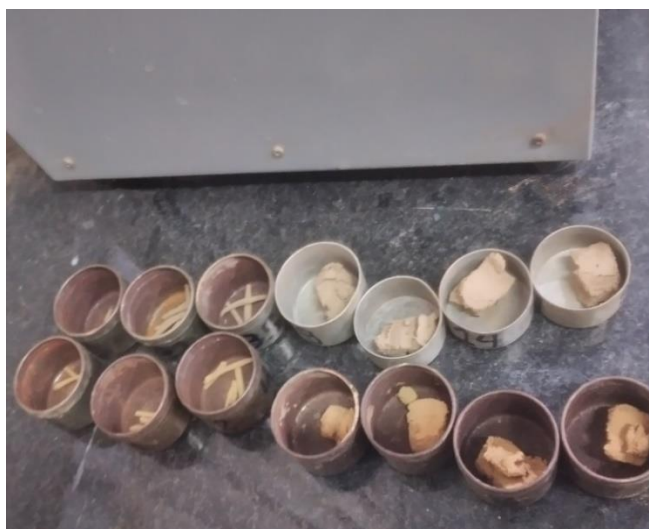
Ensayo de límite plástico mediante rodillos
