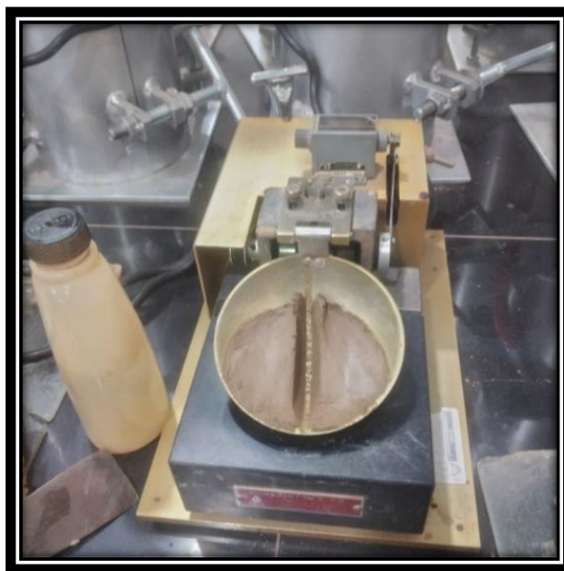
Ensayo de copa de Casa Grande para determinar el límite líquido, laboratorio de suelos, carrera de ingeniería civil
