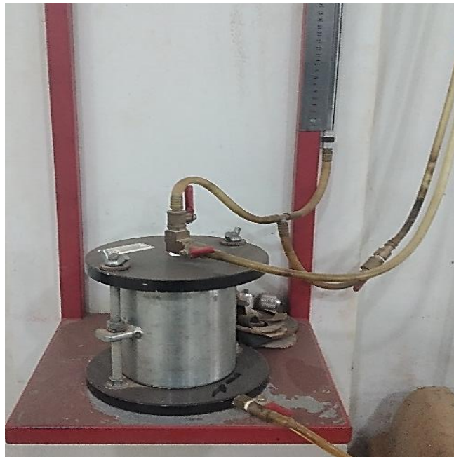
Permeámetro a carga constante del laboratorio de suelos, carrera de ingeniería civil
