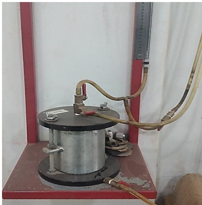
Permeámetro a carga constante del laboratorio de suelos
