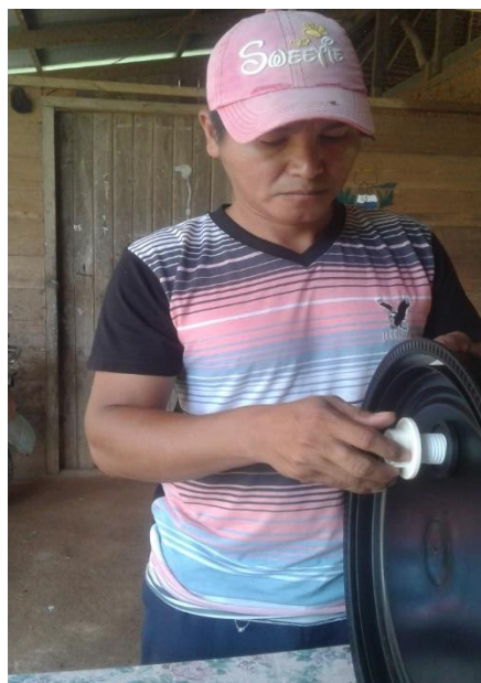
Grafico 19 Colocando el adaptador o Flanchi
