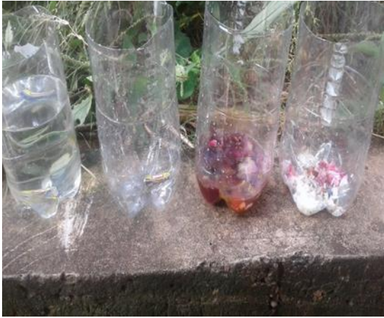
Experimento de la degradación de las pilas en 4 ambientes diferentes
