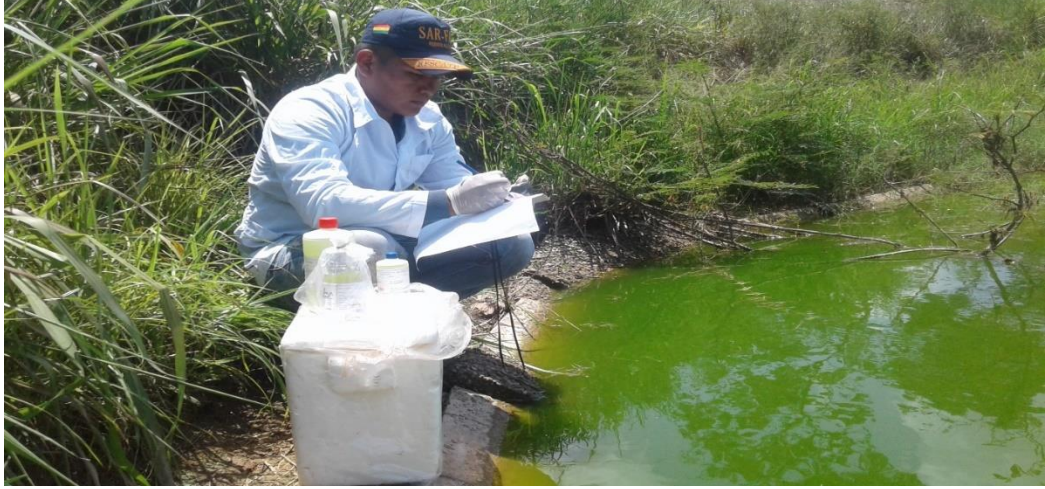
Fotografía 1 Toma de Muestra del Agua Residual en la Planta de Tratamiento de Riberalta
