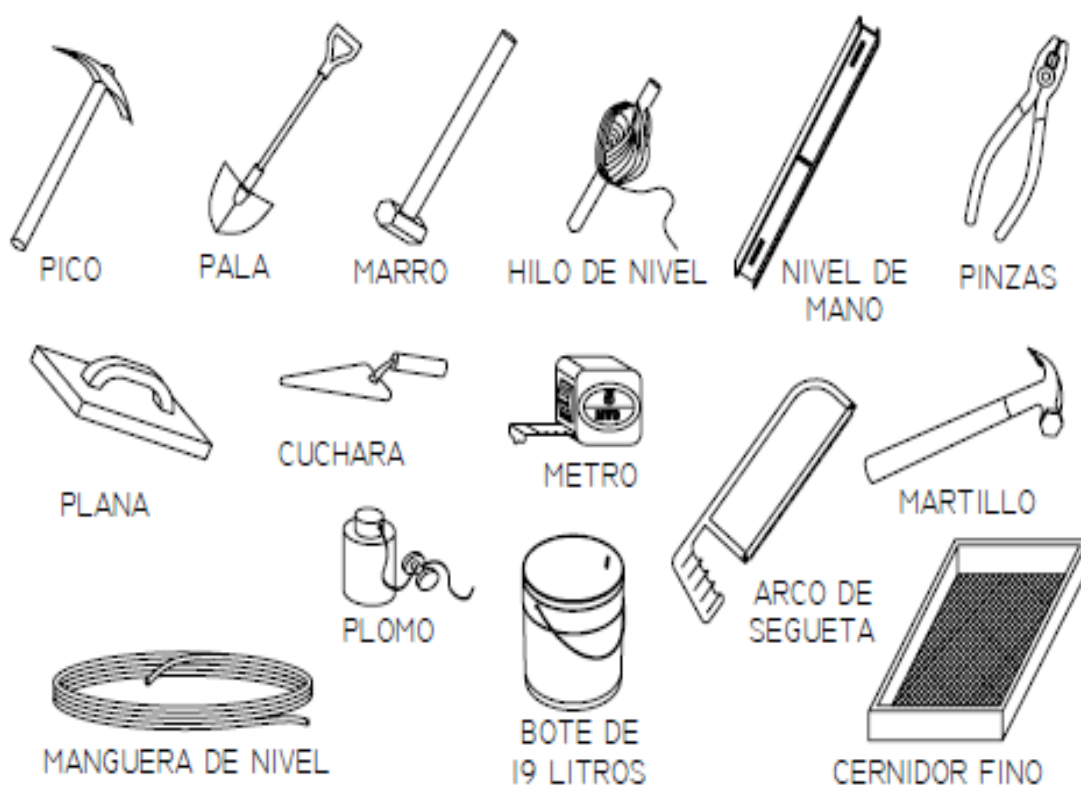
Figura 27: Materiales y herramientas para la construcción del sanitario ecológico seco
