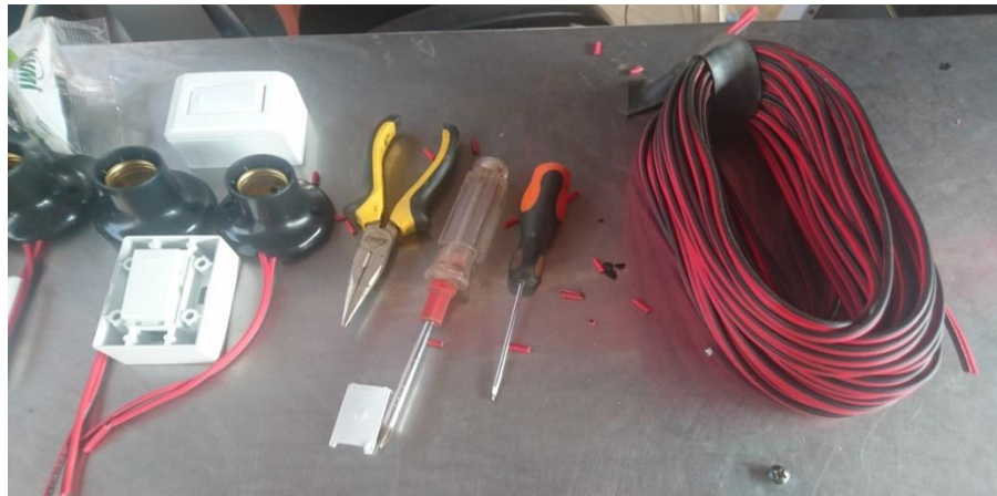
Figura 25. Cable flexible de 14 AVG utilizado para el sistema de iluminación.
