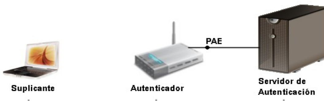
FIGURA 2.8: Estructura de control de acceso y autenticación
