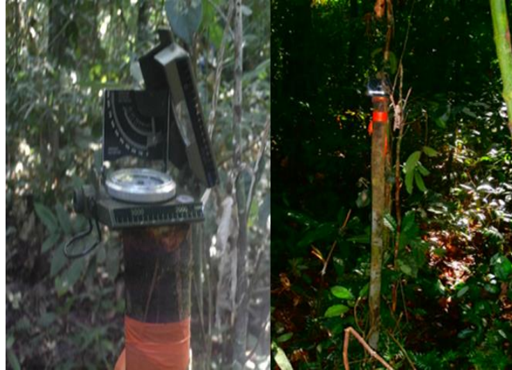
Figura 4. Punto de inicio de la instalación de la parcela permanente y determinación de rumbo a partir de este.
