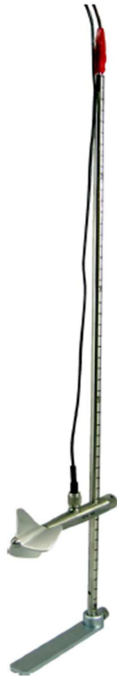
fig. 7: Mini molinete M1 sobre barra 9 mm dia.
