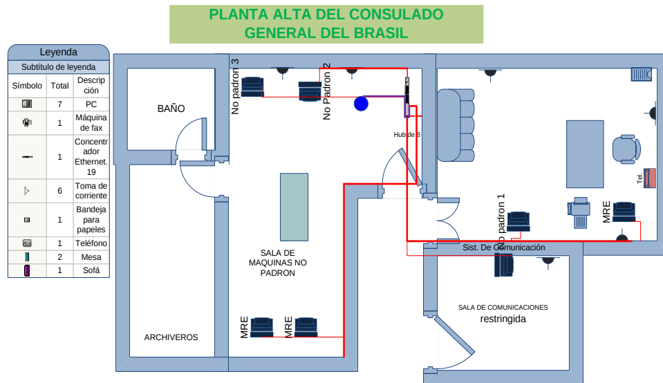
Figura 3.6: Reestructuración parcial de la red de datos.
