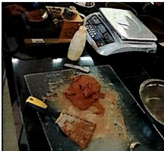
Figura 4.8 Muestra para determinar los límites de Consistencia.
