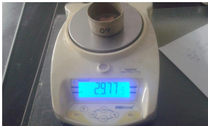
Figura 4.6 Muestra para determinar Contenido de Humedad
