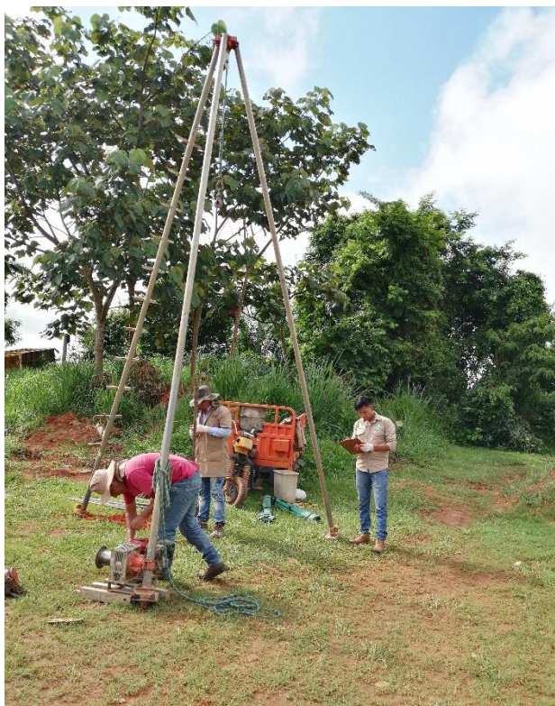
Figura 4.3. Vista panorámica del ensayo de S.P.T.
