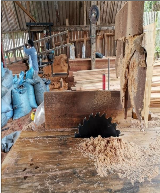
Figura 11 Falta de orden y limpieza Fuente: Elaboracion propia
