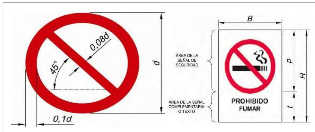
Figura 13. Dimensiones De La Señal Y La Forma De Cartel De Prohibición Fuente: Norma De Señalización De Seguridad, Salud en el Trabajo y Emergencias de Defensa Civil
