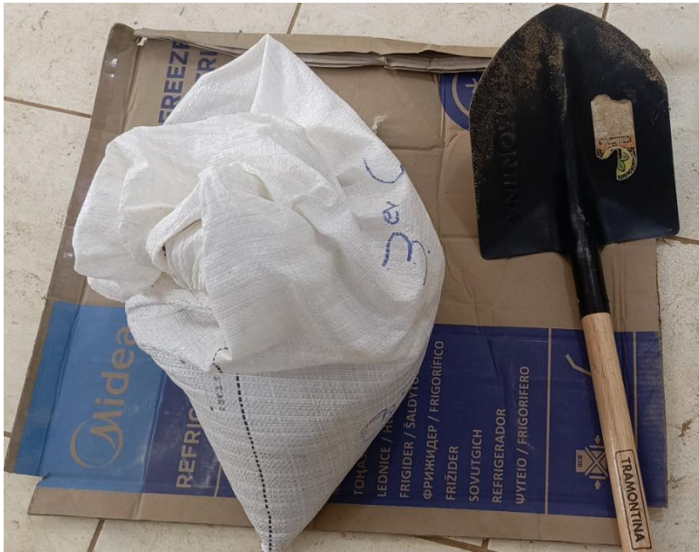
Materiales y equipo para método del cuarteo
