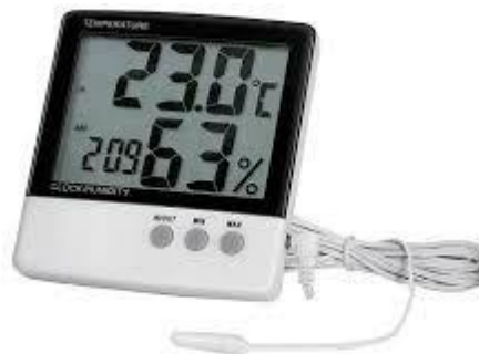
Figura 7: Equipo para la medición de temperatura y humedad.
