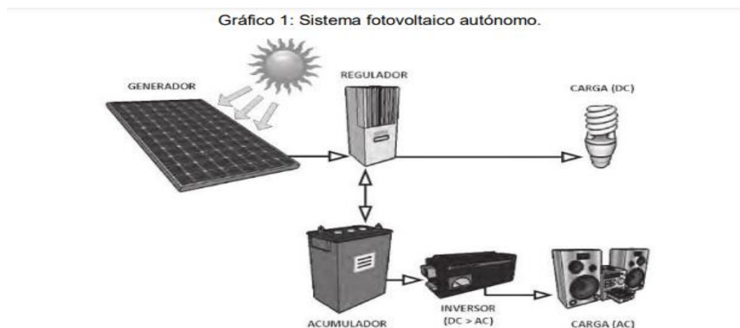
Figura 6. Sistema fotovoltaico. Foto sacada de Google.
