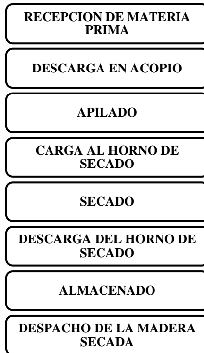
Grafico 3. Flujograma proceso del secado
