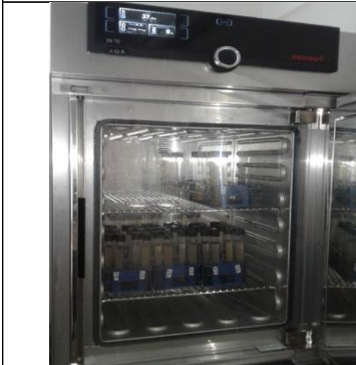
Foto 17: encuvacion de coliformes toytales y fecales.
