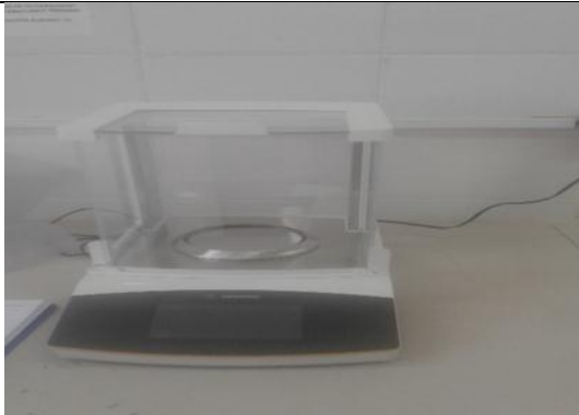
Foto 11: Balanza de pesado de sólidos
