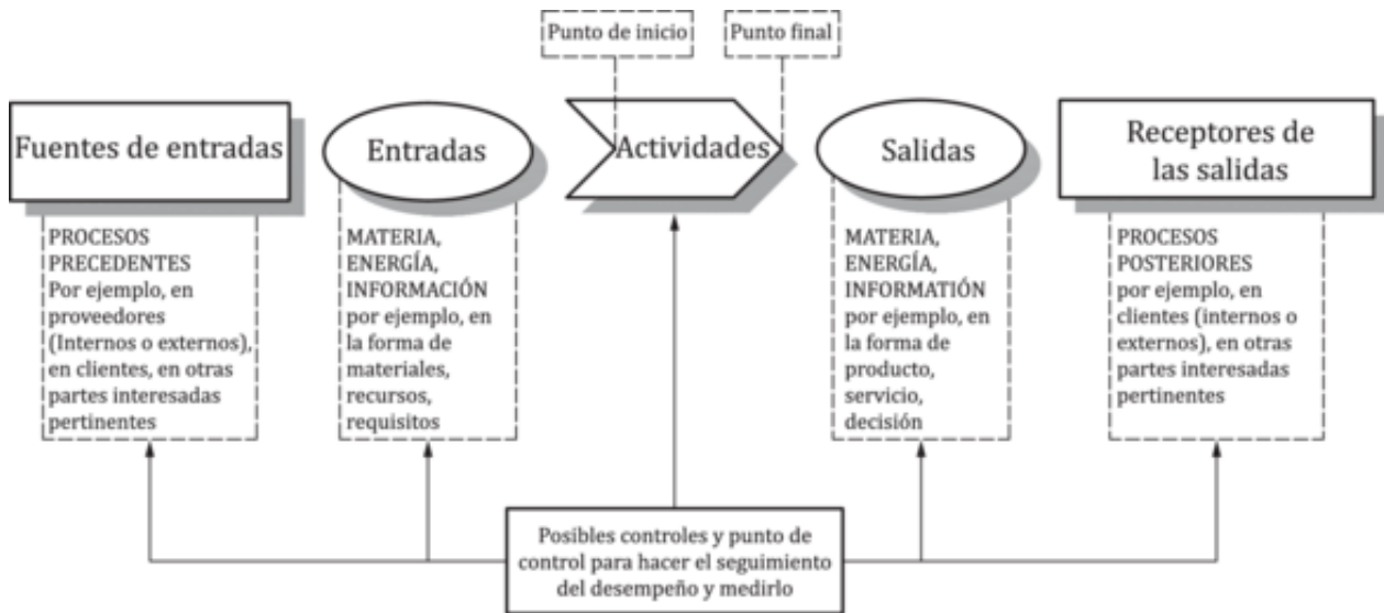
FIGURA 2.2 Este diagrama SIPOC Representa el esquema de los elementos del proceso de norma ISO 9001:201.
